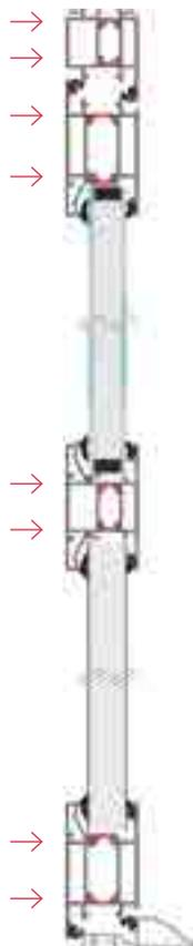
**Technologique :** ce système vous permet de modérer la température à l'intérieur de votre garage. La rupture de pont thermique est réalisée grâce à l'utilisation de barrettes avec fibres de verre 100% recyclables.
